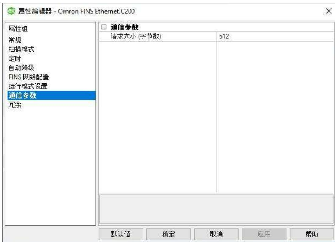
**“请求大小”:** 此参数用于指定从设备上一次可以请求的最大字节数。默认设置为 512 字节。要优化驱动程序的性能, 请将请求大小设置为以下设置之一: 32、64、128、256、512、1024 或 1984 字节。
