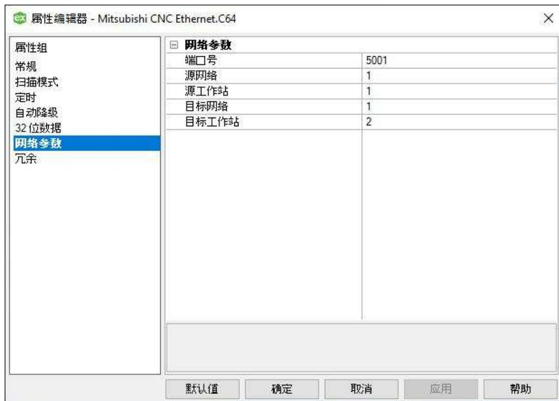
**“端口号”:** 此属性用于指定目标 CNC (或网关设备 (如果将多层网络配置为接收请求)) 的 UDP 端口。默认设置为 5001。
