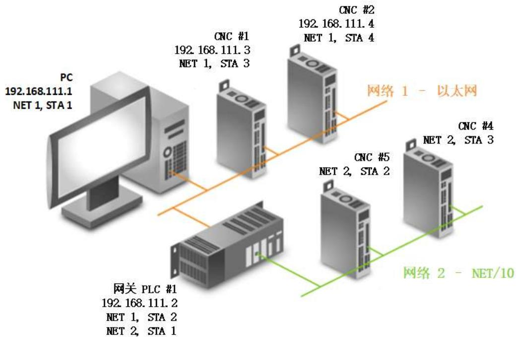
网关具有 AJ71QE71 以太网模块和 NET/10 模块。CNC 1 和 CNC 2 具有 AJ71QE71 以太网模块和 NET/10 模块。CNC 3 和 CNC 4 具有 NET/10 模块。在此示例中，使用下表中列出的设备 ID 在服务器项目中创建四个设备。
