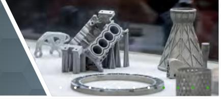
Creo를 사용하면 단일 환경 내에서 설계, 최적화, 검증, 인쇄 확인 실행을 모두 수행할 수 있으므로 시간과 번거로운 작업 및 실수를 줄일 수 있습니다. Creo에서는 적층 가공용으로 설계를 쉽게 최적화할 수 있습니다. 새롭게 제공되는 적층 기능에서는 고급 격자 구조를 사용해 무게를 최소화할 수도 있고, 시뮬레이션 결과를 기준으로 가변 격자 구조를 적용할 수도 있습니다.
