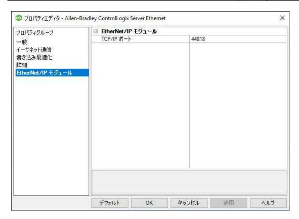
「TCP/IP ポート」: イーサネット/IP モジュールに一意の通信チャネルを提供する TCP/IP または UDP ポートを指定します。 有効な範囲は 1 から 65535 です。 デフォルトは 44818 です。
