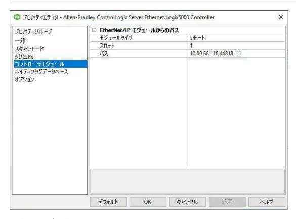
「モジュールタイプ」: デバイスがローカル (シミュレーション対象の EtherNet/IP モジュールの一部) かリモート (EtherNet/IP ルーティング用のスロット番号が必要) かを確認します。1 つのローカル CPU と最大 15 個のリモート CPU が存在します。
