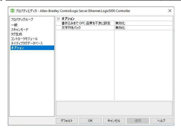
「書き込みまで OPC 品質を不良に設定」: ネイティブタグへの書き込みが発生するまでドライバーが品質として「不良」を返すようにするには、「有効化」を選択します。書き込み操作は、クライアントインタフェース (OPC など) または ControlLogix クライアント (ControlLogix 5000 シリーズ PLC など) から発生する可能性があります。配列の 1 つのアイテムに対する書き込みが発生すると、配列全体が初期化され、品質として「良好」が返されます。デフォルトでは無効になっています。起動時に、Allen-Bradley ControlLogix サーバードライバーは整数/数値データ型の値をゼロ (0) に初期化し、文字列を空にします。デフォルトではクライアントは初回の更新で品質として「良好」を受信しますが、この動作はデバイスごとに修正可能です。
