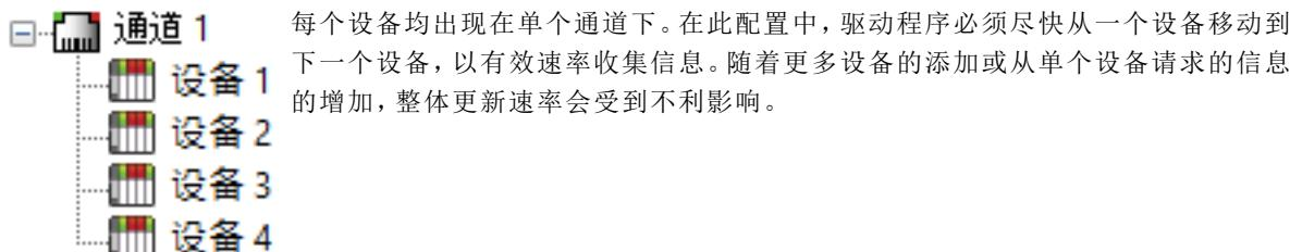
如果 Allen-Bradley Micro800 Ethernet 驱动程序 只能定义一个单通道，则上述示例将是唯一可用的选项；但是，驱动程序最多可以定义 256 个通道。使用多个通道，可通过同时向网络发出多个请求来分发数据集合工作载荷。下面显示了使用多个通道来提高性能时相同应用程序所呈现效果的示例。
