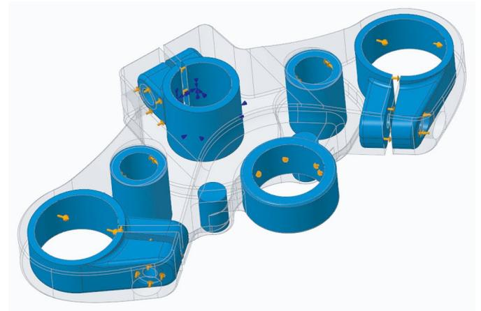
透過定義設計空間、物理特性、負載與條件約束、目標、製造流程和材料，輕鬆設定最佳化作業。快速執行初始模擬，可確保正確設定研究。
