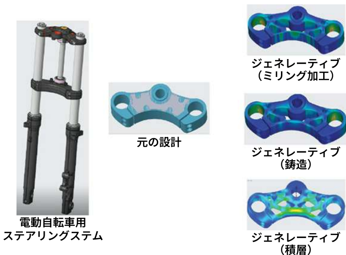
図 3-2： ジェネレーティブデザインによる部品材料削減の例
