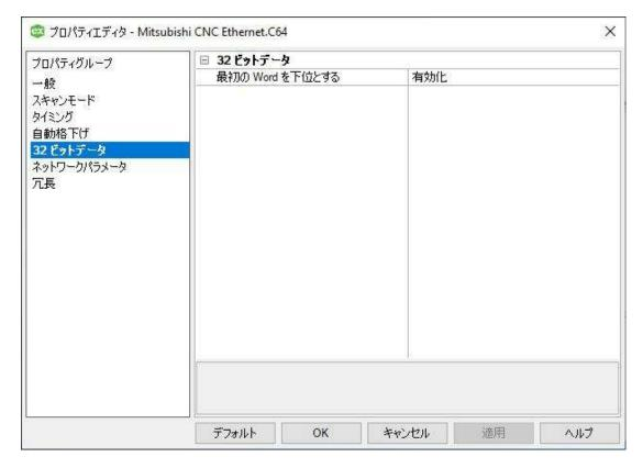
「最初のWord を下位とする」: 最初のデータ Word が環境下で (上位ではなく) 下位であることを示します。 三菱デバイスでは 32 ビットデータ型に 2 つの連続するレジスタアドレスが使用されます。 ドライバーが最初の Word を 32 ビット値の下位 Word とするか上位 Word とするかを指定できます。 デフォルトでは「最初の Word を下位とする」が「有効化」になっています。
