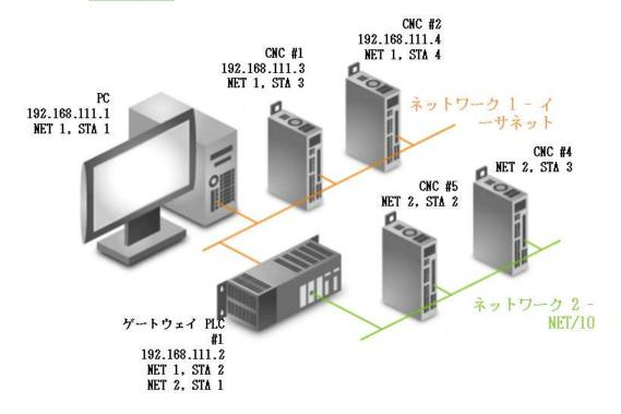
ゲートウェイには AJ71QE71 イーサネット モジュールと NET/10 モジュールが組み込まれています。 CNC 1 と CNC 2 には AJ 71QE 71 イーサネット モジュールと NET/10 モジュールが組み込まれています。 CNC 3 と CNC 2 には NET/10 モジュールが組み込まれています。 この例では、以下の表に示すデバイス ID を使用してサーバープロジェクト内に 4 つのデバイスが作成されています。
