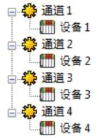
各デバイスを、そのデバイス専用のチャネルの下で定義することができます。この構成では、 各デバイスからのデータ収集タスクごとに1つの実行パスが割り当てられます。アプリケーション のデバイスの数が256台以下の場合、ここで説明した方法で最適化することができます。
