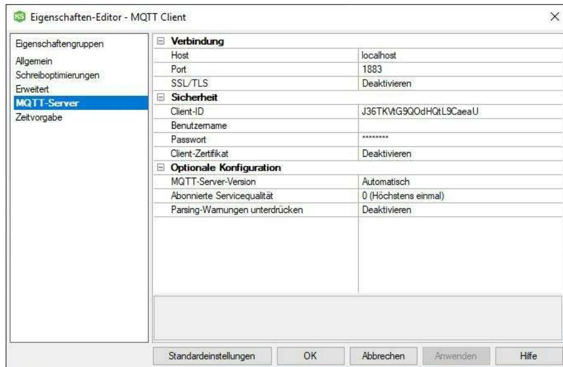
**Host:** Die IP-Adresse oder der Host-Name des MQTT-Servers, zu dem eine Verbindung hergestellt werden soll. Die Standardeinstellung ist "localhost".
