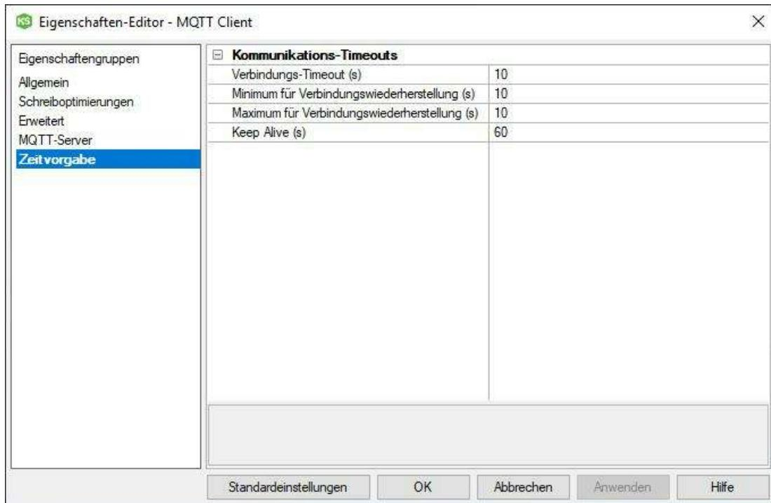
**Verbindungs-Timeout (s):** Geben Sie an, wie viele Sekunden der Client auf eine Bestätigung der Verbindung durch den MQTT-Server wartet. Der gültige Bereich für die Option **Verbindungs-Timeout (s)** liegt zwischen 1 Sekunde und 600 Sekunden.
