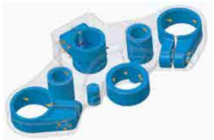
Einfache Konfiguration der Optimierung durch Definition von Konstruktionsraum, Physik, Lasten und Randbedingungen, Zielen, Fertigungsprozess und Materialien. Führen Sie kurz eine erste Simulation durch, um sicherzustellen, dass die Studie korrekt eingerichtet ist.
