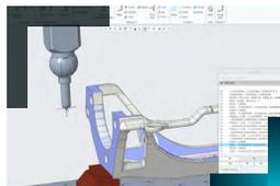
*Programmazione macchina per misurazione coordinate (CMM) per ispezione digitale della qualità:*
