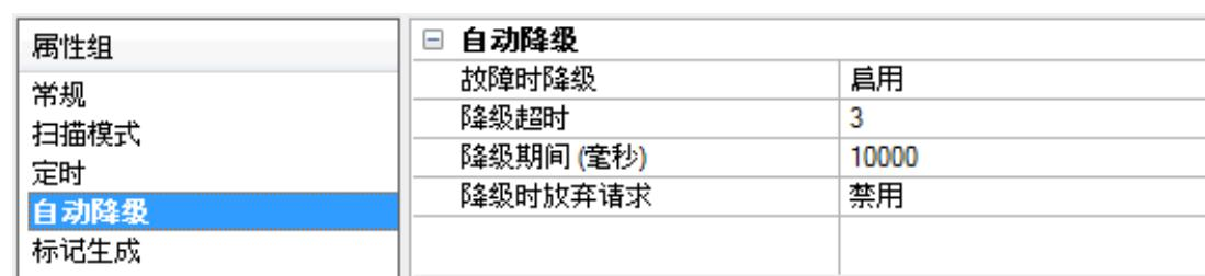
**“故障时降级”:**启用后, 将自动对设备取消扫描, 直到该设备再次响应。
