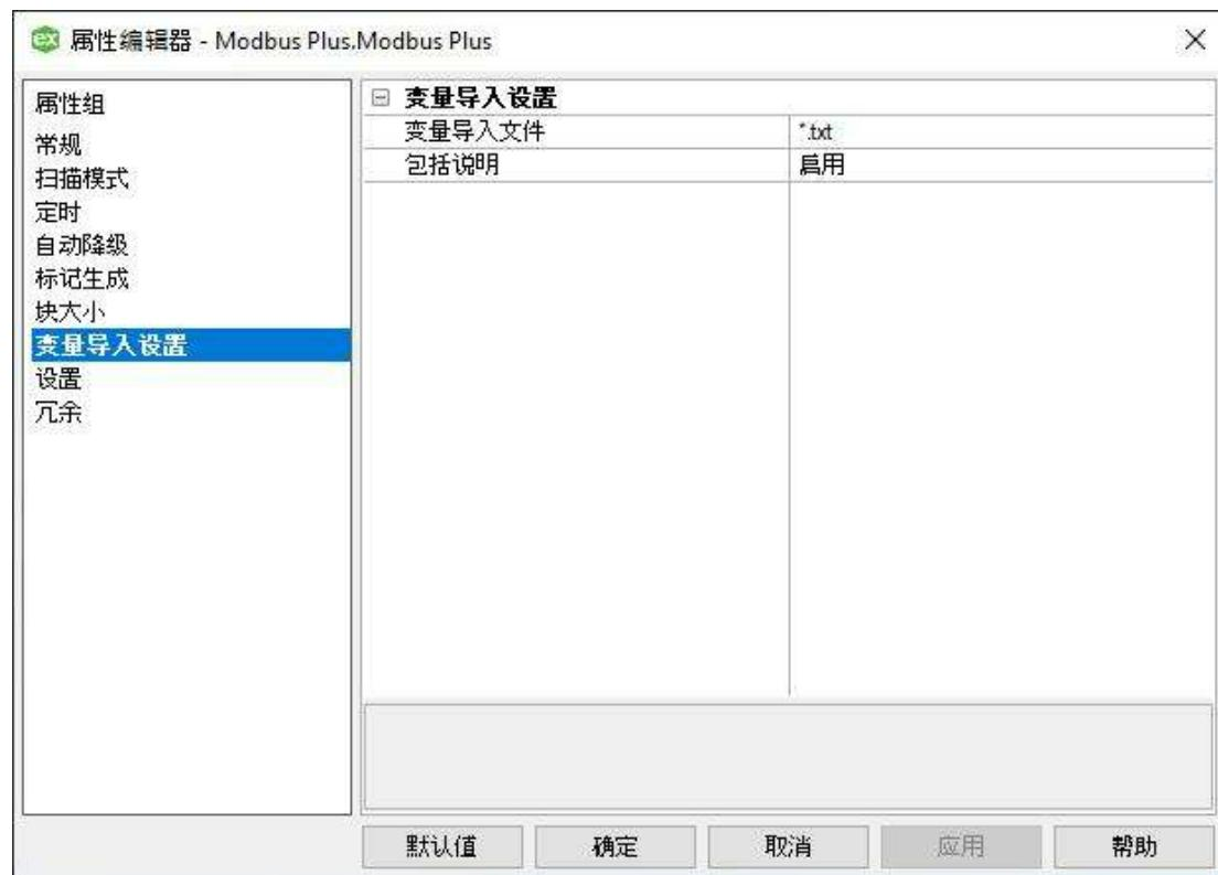
**“变量导入文件”:**指定该设备启用自动标记数据库生成时驱动程序使用变量导入文件的确切位置。
