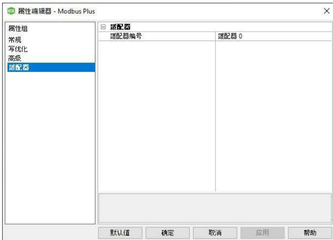
**“适配器编号”**: 指定 Modbus Plus 卡将使用的适配器编号。有效适配器编号为 0 至 3。有关卡的特定信息，请参阅[设置](#)。
