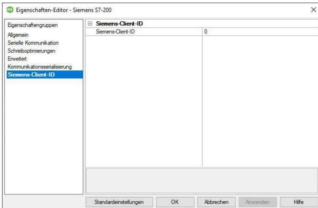
Siemens-Client-IDSiemens S7-200-Treiber: Geben Sie die von im Netzwerk verwendete Knotennummer an. Jeder Kanal muss eine eindeutige Siemens-Client-ID aufweisen. Der gültige Bereich liegt zwischen 0 und 126.
