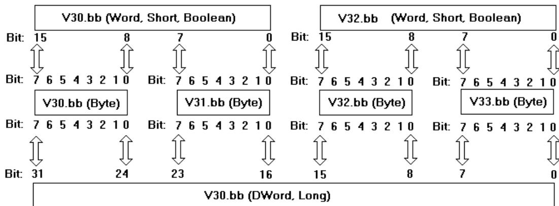
● **Hinweis:** V30.10@bool, V30.2@byte und V30.26@DWord referenzieren alle dasselbe Bit im Controller.
