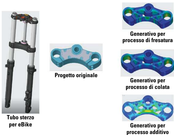
FIGURA 3-2: esempio di generative design che ha permesso di ridurre il materiale di un componente.
