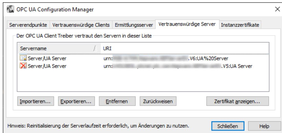
**Importieren...:** Wird diese Schaltfläche geklickt, so wird ein vertrauenswürdiges Serverzertifikat importiert.
