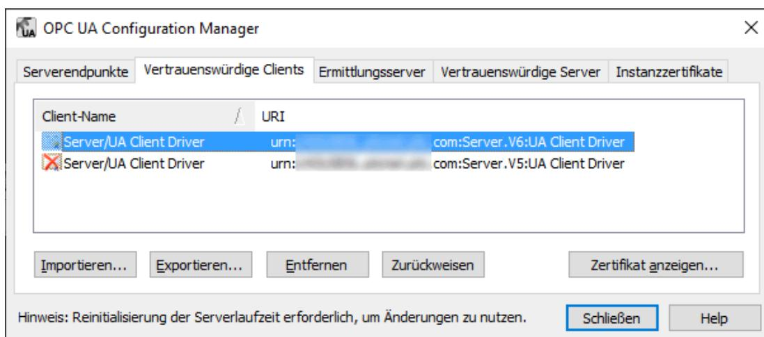
**Importieren...:** Wird diese Schaltfläche geklickt, so wird ein vertrauenswürdiges Client-Zertifikat importiert.
