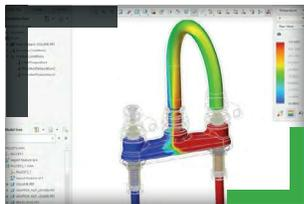
**Expansión de la optimización y la simulación.** Con el diseño generativo de Creo puede disfrutar de una configuración de optimización más sencilla con envoltura automática, así como de una mayor compatibilidad con los diseños de fundición. Creo Simulation Live incluye ahora soporte para fluidos en estado estable\*.
