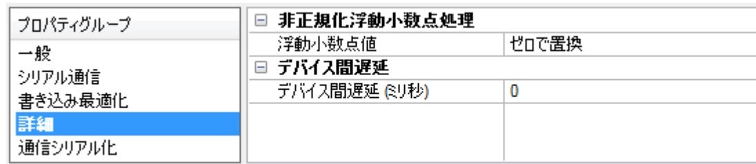
「**非正規化浮動小数点処理**」: 非正規化値は無限、非数 (NaN)、または非正規化数として定義されます。デフォルトは「ゼロで置換」です。ネイティブの浮動小数点処理が指定されているドライバーはデフォルトで「未修正」になります。「**非正規化浮動小数点処理**」では、ドライバーによる非正規化 IEEE-754 浮動小数点データの処理方法を指定できます。オプションの説明は次のとおりです。
