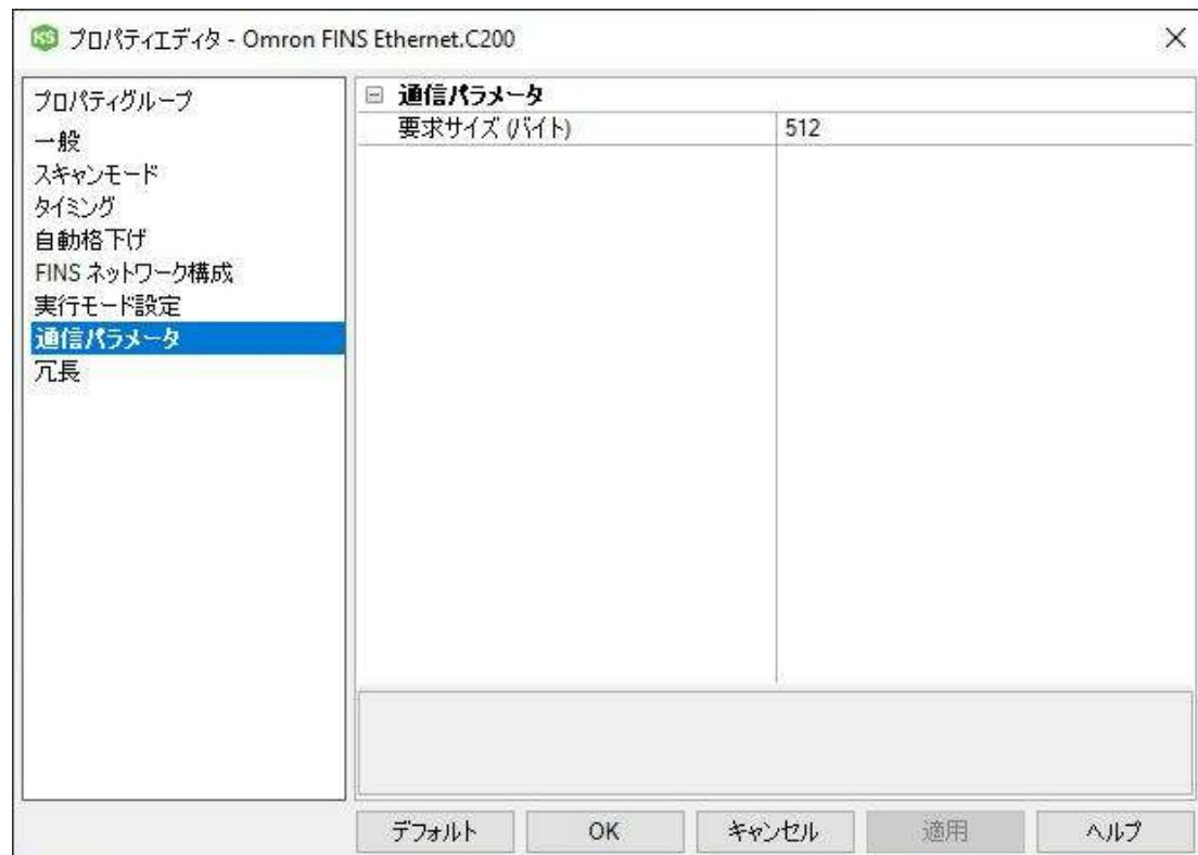
「要求サイズ」: このパラメータでは、デバイスから一度に要求可能な最大バイト数を指定します。デフォルトの設定は 512 バイトです。ドライバーのパフォーマンスを微調整するには、要求サイズを 32、64、128、256、512、1024、1984 バイトのいずれかに設定します。
