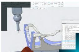
*Programmation de machine à mesurer tridimensionnelle (CMM) pour inspection numérique de la qualité :*
