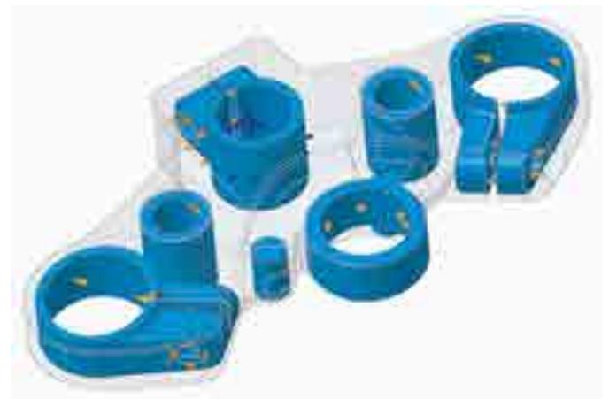
설계 공간, 물리, 하중과 제약 조건 목표, 제조 공정 및 재료를 정의하여 손쉽게 최적화 설정 조사가 올바르게 설정되어 있는지 확인하기 위해 초기 시뮬레이션을 신속하게 실행합니다.
