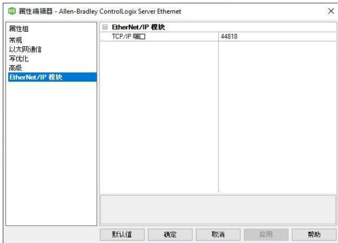
**“TCP/IP 端口”:** 用于指定为 EtherNet/IP 模块提供唯一通信通道的 TCP/IP 和 UDP 端口。有效范围为 1 到 65535。默认值为 44818。
