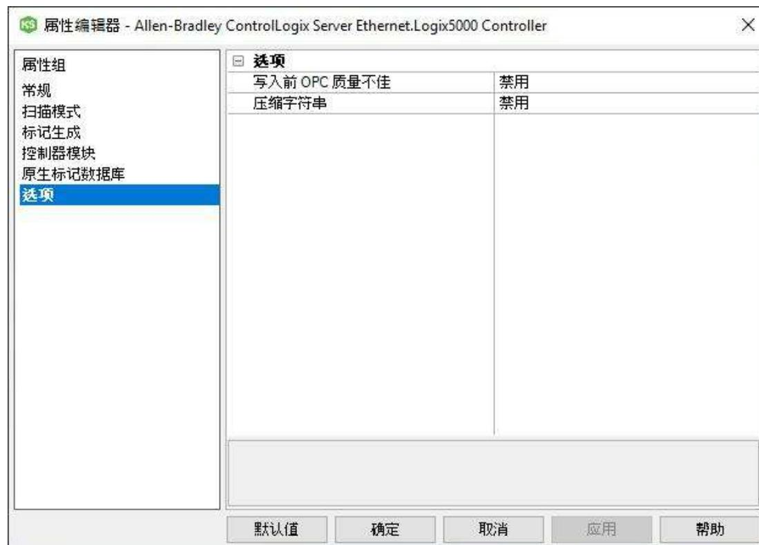
**"写入前 OPC 质量不佳":** 选择"启用"可在写入原生标记前强制驱动程序返回"质量不佳"消息。可能会从客户端接口 (如 OPC) 或从 ControlLogix 客户端 (如 ControlLogix 5000 系列 PLC) 写入。当向数组的单个项目写入时, 整个数组会进行初始化, 并会返回"质量良好"消息。默认设置为禁用状态。启动时, Allen-Bradley ControlLogix Server 驱动程序会将整型/数字数据类型值初始化为零 (0), 并将字符串初始化为空。默认情况下, 客户端接收具有"良好质量"的初始更新;但是, 可以针对每个设备修改此行为。
