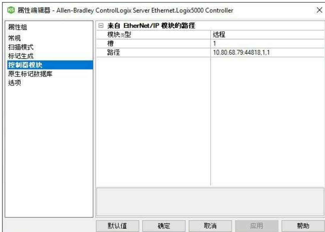
**“模块类型”:** 用于验证设备为“本地”(模拟 EtherNet/IP 模块的一部分)还是“远程”(这需要为 EtherNet/IP 路由提供一个插槽编号)。可以存在一个本地 CPU 和最多 15 个远程 CPU。
