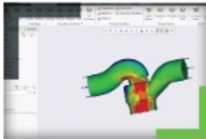
**Leistungsfähigere Tools für simulationsgetriebenes Design.** Creo Simulation Live jetzt mit Echtzeit-Flüssigkeitsströmungssimulation sowie Parameterstudien, Plots/grafischen Darstellungen und transienten thermischen Studien.
