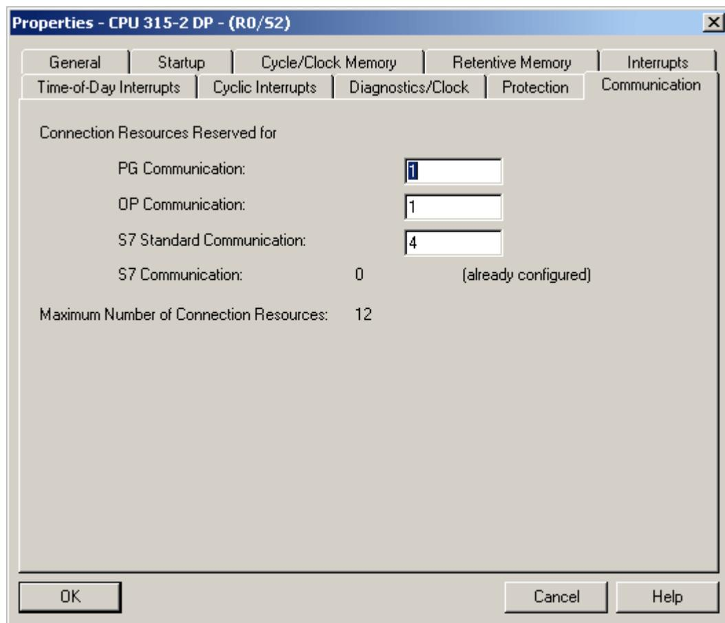
3. 配置所需的 **PG/OP** 和“**PC (S7 通信)**”(**PC (S7 Communication)**) 连接数。
