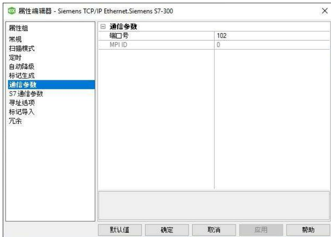
**“端口号”:** 此参数用于指定远程 CP 配置使用的端口号。TCP/IP 的默认设置是 102 (TSAP)。NetLink 的默认设置为 1099。
