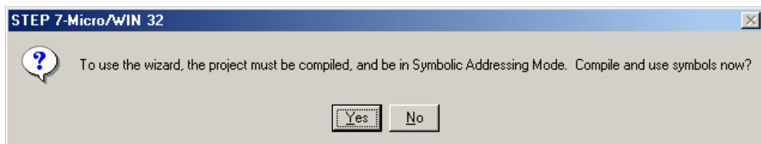
● 注意：必须先对程序进行编译，才能执行以太网向导。请先纠正程序中的所有错误再继续操作。
