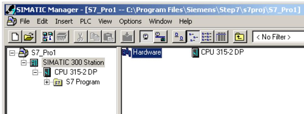
2. 如果是新 Simatic 项目，在“硬件配置”的“机架”中添加必要的模块。要在 Siemens TCP/IP Ethernet 驱动程序与 CPU 之间建立通信，至少需要一个支持“**S7 通信**”的以太网模块。这可能内置于 CPU 中。
