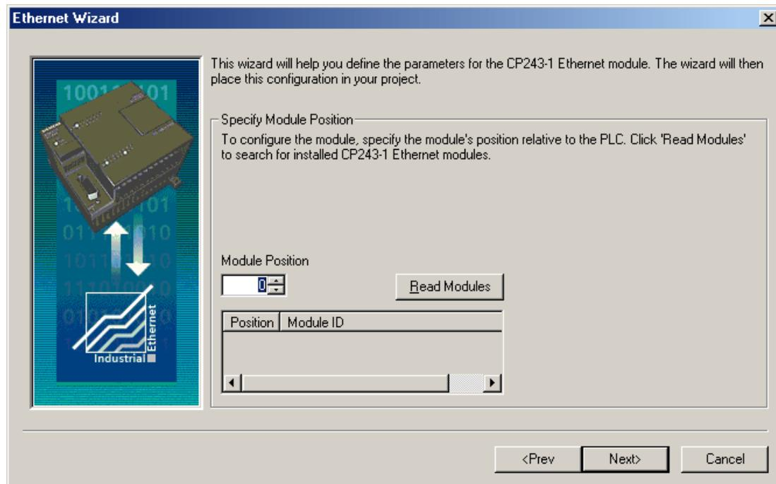
**注意:** 虽然建议使用“读取模块”功能，但这需要将 PLC 通过串行端口或以太网连接到 PC。在任一情况下，均须正确设置 **Micro/WIN** 通信参数才能执行“读取模块”操作。
