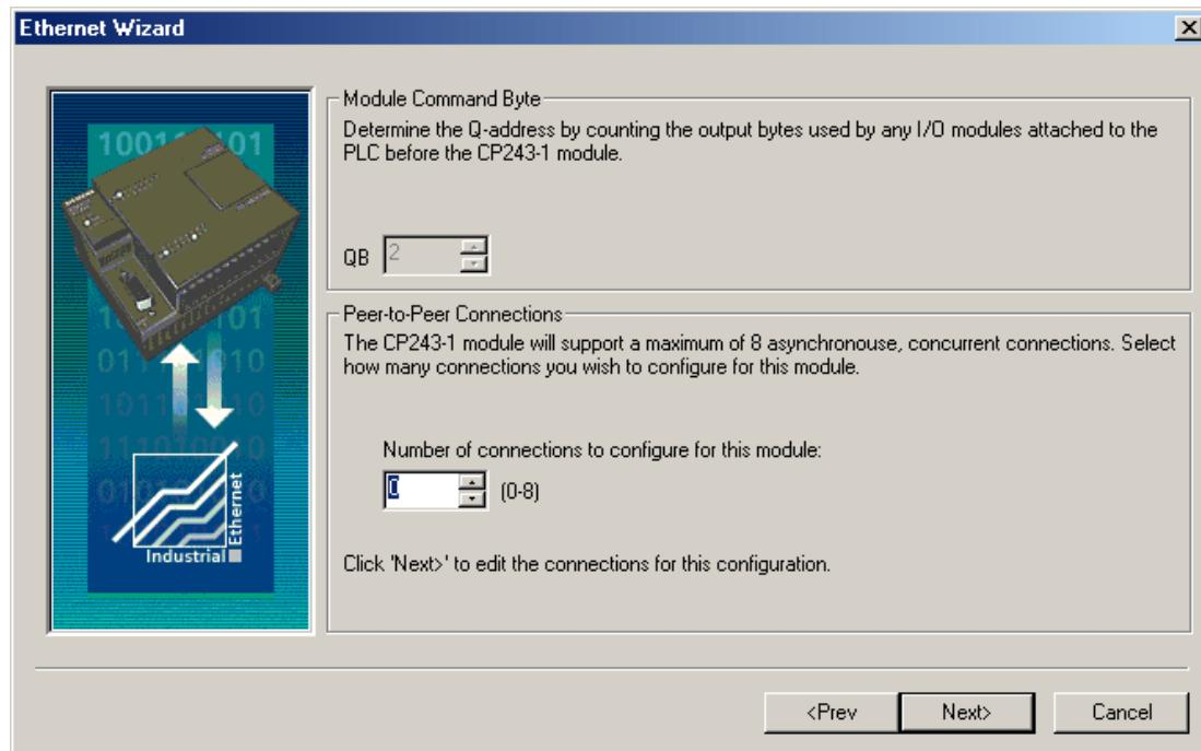
**注意:** 所选的连接数决定了 PLC 可支持的同时连接数。如果打算仅允许一台 OPC 服务器与 PLC 通信, 请仅设置一个连接。这样可确保 OPC 服务器的最佳性能。如果打算与 PLC 建立多个活动连接, 请使用多个连接。但请记住, 使用每个连接都会影响模块的性能。
