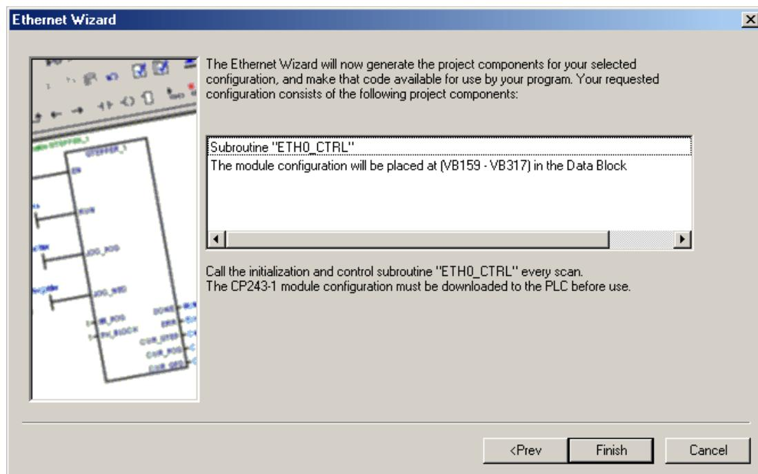
2. 要查看以太网向导生成的内容, 双击“**程序块**”(Program Block)下的 **ETH0\_CTRL**。此外列出了所有已配置的 **TSAP** 以供将来参考。请记住, 下面的“**本地 TSAP**”其实是 OPC 服务器中的“**远程 TSAP**”, 下面的“**远程 TSAP**”其实是 OPC 服务器中的“**本地 TSAP**”。
