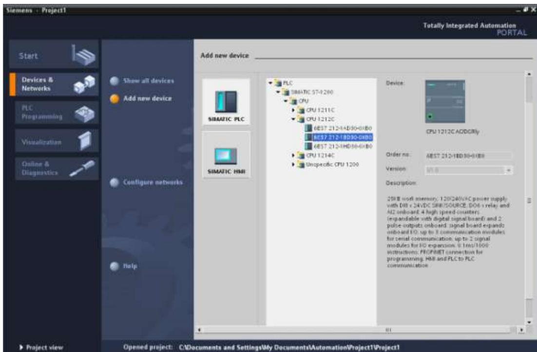
12. 接下来，选择设备的配置，然后单击“添加设备”(Add device)。此操作将调用“项目”视图，进一步配置设备硬件。
