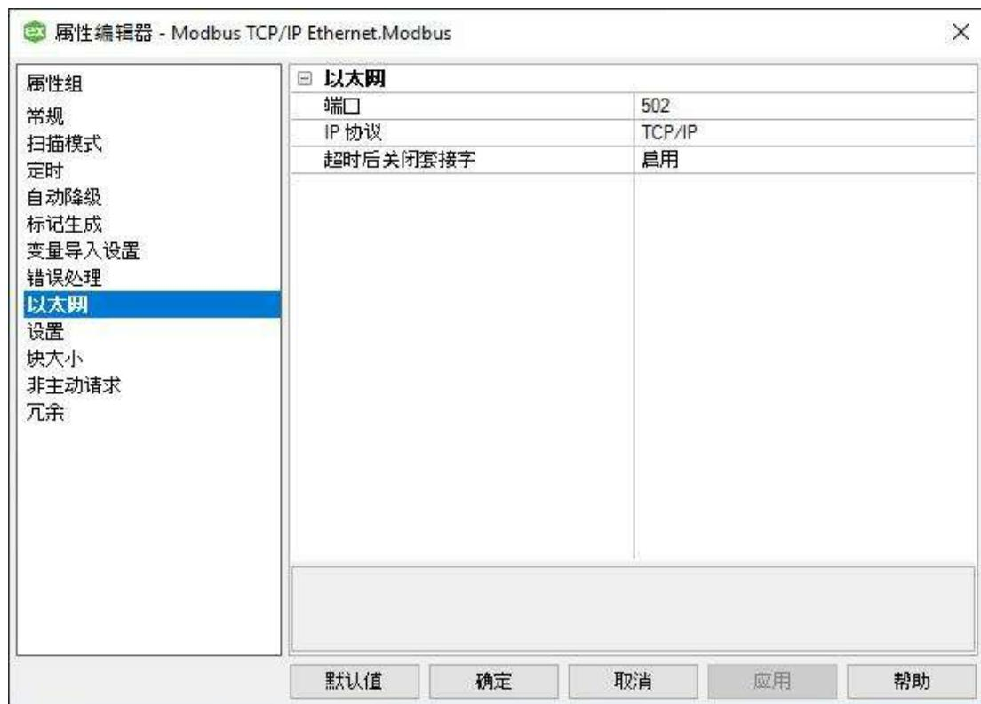
**“端口”:** 指定配置远程使用的端口号。有效范围为 0 到 65535。默认值为 502。当设备对象处于 Modbus 客户端模式并向设备发出主动请求时, 将使用该端口号。
