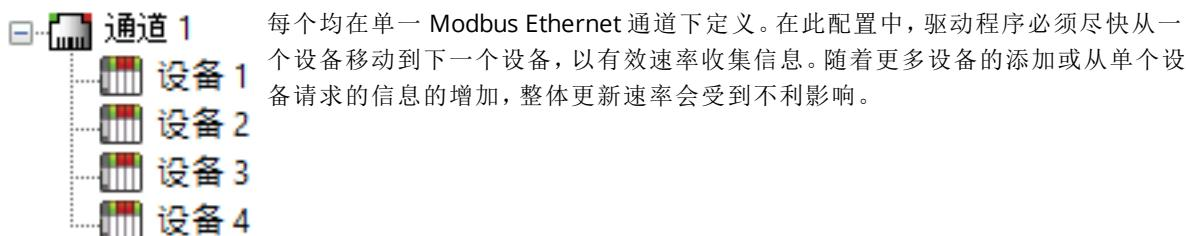
如果 Modbus TCP/IP Ethernet 驱动程序 只能定义一个通道，则上述示例将是唯一可用的选项；但是，驱动程序最多可以定义 1024 个通道。使用多个通道，可通过同时向网络发出多个请求来分发数据集合工作载荷。下面显示了使用多个通道来提高性能时相同应用程序所呈现效果的示例。
