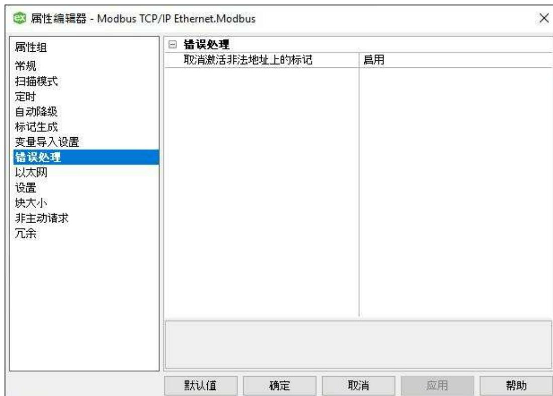
**“取消激活非法地址上的标记”：**选择“启用”可让驱动程序在设备读取某个数据块的响应过程中返回 Modbus 异常代码 2（非法地址）或 3（点数之类的非法数据）时，停止轮询该数据块。选择“禁用”可让驱动程序继续轮询该数据块而不管发生了什么错误。默认设置为已启用。
