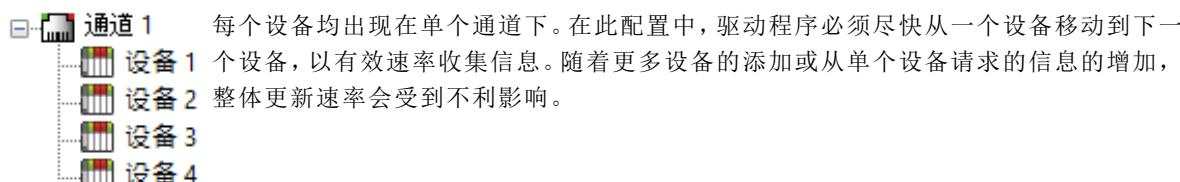
如果 Omron NJ Ethernet 驱动程序 仅可以定义一个通道，则项目所需的所有设备必须在该通道下方创建；但是，驱动程序最多可以定义 256 个通道。使用多个通道，可通过同时向网络发出多个请求来分发数据集合工作载荷。下面显示了使用多个通道来提高性能时相同应用程序所呈现效果的示例。
