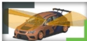
**Progettazione ergonomica migliorata.** I più recenti miglioramenti di Creo consentono di tenere conto dell'intervallo di movimento, del campo visivo e dell'unicità degli utenti in modo sicuro ed efficiente. Il campo visivo è in grado di eseguire l'analisi riflesso e i manichini possono supportare più involuipi a portata.
