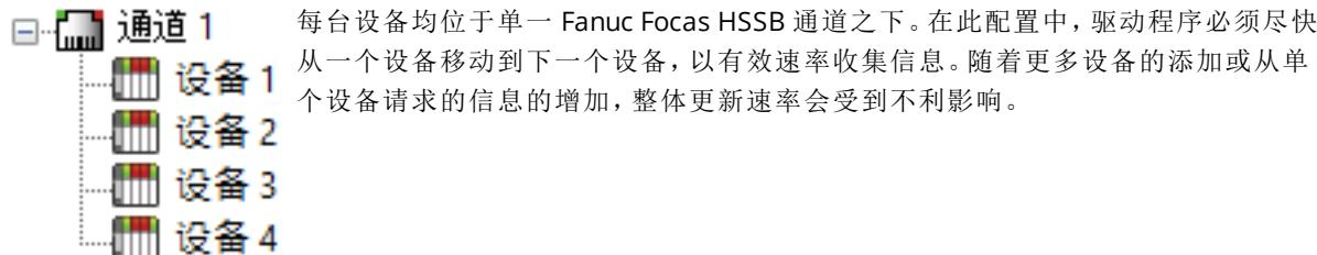
如果 Fanuc Focas HSSB 驱动程序 只能定义一个单通道，则上述示例将是唯一可用的选项；但是，驱动程序最多可以定义 100 个通道。使用多个通道，可通过同时向网络发出多个请求来分发数据集合工作载荷。下面显示了使用多个通道来提高性能时相同应用程序所呈现效果的示例。
