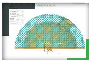
**幅広い切削加工機能と付加製造機能。**最新の付加製造機能を使用して、ビームベースの新しい格子タイプを作成したり、IWP セル格子の作成をサポートすることができます。切削加工では、高速ミリングがウォールとフロアの両方の 5 軸仕上げのバレルツールをサポートできるようになりました。
