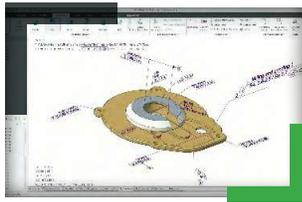
**より簡単なモデルベース定義 (MBD) と詳細図面。**表面仕上げシンボルの作成、配置、編集のための直感的なワークフローが、最新の ASME および ISO 標準に準拠したセマンテック表面仕上げアノテーションとともに提供されます。新しい図面ハッチングパターンにより、詳細図面もさらに簡単になりました。
