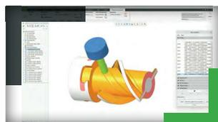
**幅広い切削加工と付加製造。** 高品質で製造可能な製品を簡単に提供できます。最新の付加製造により複雑な格子を簡単に製造できます。除去製造では、高速ミリングが 4 軸ロータリー荒削りと仕上げのツールパスをサポートするようになりました。
