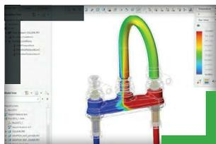
**最適化とシミュレーションの拡張。** Creo Generative Design を使用すると、自動エンベロープにより最適化設定が容易になるほか、鋳造設計のサポートも拡張されます。Creo Simulation Live に定常状態の流体解析がサポートされました。\*
