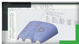
**強化された複合設計機能。** 遷移、積層断面、ドレーピングシミュレーションの拡張された機能を活用しています。ゾーンベースの設計でプライを自動的に作成します。トップクラスのレーザー投影フォーマットを通じて複合素材製品の品質を高めます。
