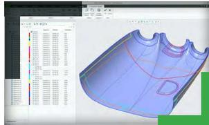
**新しい複合設計機能。**Creo に新しい専用の複合設計機能と製造環境を導入しています。幅広い一連の機能が提供されているため、個々のプライレイアッ、プライセクション、遷移、プライ順序を定義できるほか、結果のソリッドジオメトリや内部モールドライン (IML) キルトを作成することもできます。構造を最適化して、強力でありながら軽量の結果が得られます。
