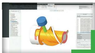
**幅広い切削加工と付加製造。** 高品質で製造可能な製品を簡単に提供できます。最新の付加製造により複雑な格子を簡単に製造できます。除去製造では、高速ミリングが 4 軸ロータリー荒削りと仕上げのツールパスをサポートするようになりました。
