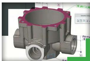
**より簡単なモデルベース定義 (MBD) と詳細図面。** 最新のシンボルインターフェースにより、モデルベース定義のワークフローが簡略化されます。GD&T Advisor がアセンブリを的確にサポートします。
