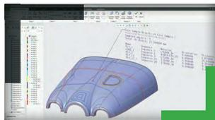
**強化された複合設計機能。** 遷移、積層断面、ドレーピングシミュレーションの拡張された機能を活用しています。ゾーンベースの設計でプライを自動的に作成します。トップクラスのレーザー投影フォーマットを通じて複合素材製品の品質を高めます。
