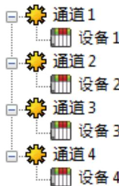
各デバイスは独自のチャンネルで定義できます。ただし、同じ IP を使用してデバイスに複数のチャンネルを作成することはお勧めしません。1 つのデバイスにつき 1 つの物理的な接続のみをプロジェクトで使用することをお勧めします。この構成では、各デバイスからのデータ収集タスクごとに 1 つの実行パスが割り当てられます。アプリケーションのデバイスの数が 256 台を超える場合であっても、パフォーマンスが向上します。デバイスの数は 256 台以下にすることをお勧めしますが、これを超える場合であっても、アプリケーションで多くのチャンネルを使用できるというメリットがあります。デバイスの負荷をすべてのチャンネルに分散してもサーバーはデバイスを切り替えますが、単一のチャンネルで処理するデバイスの数ははるかに少なくなります。
