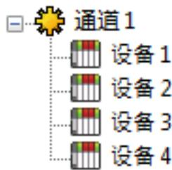
各デバイスは、単一のチャンネルの下で定義されます。この構成では、ドライバーは効果的な速度で情報を収集するために、できるだけ速やかにあるデバイスから次のデバイスに移動する必要があります。さらにデバイスが追加されたり、1 つのデバイスからより多くの情報が要求されたりするにしたいが、全体的な更新レートが低下していきます。
