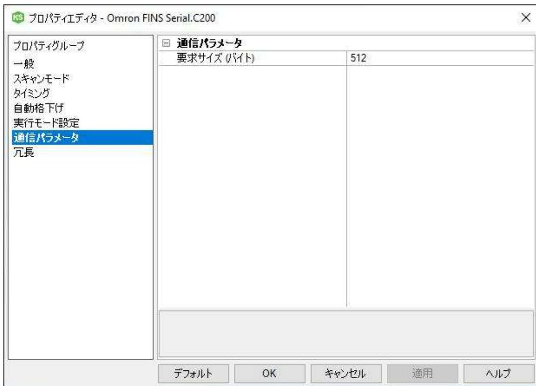
「要求サイズ」: デバイスから一度に要求可能なバイト数を指定します。ドライバーのパフォーマンスを微調整するには、「要求サイズ」を 32、64、128、256、512 バイトのいずれかに設定します。デフォルトの設定は 512 バイトです。
