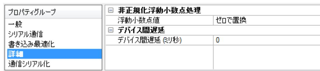
「非正規化浮動小数点処理」: 非正規化値は無限、非数 (NaN)、または非正規化数として定義されます。デフォルトは「ゼロで置換」です。ネイティブの浮動小数点処理が指定されているドライバーはデフォルトで「未修正」になります。
