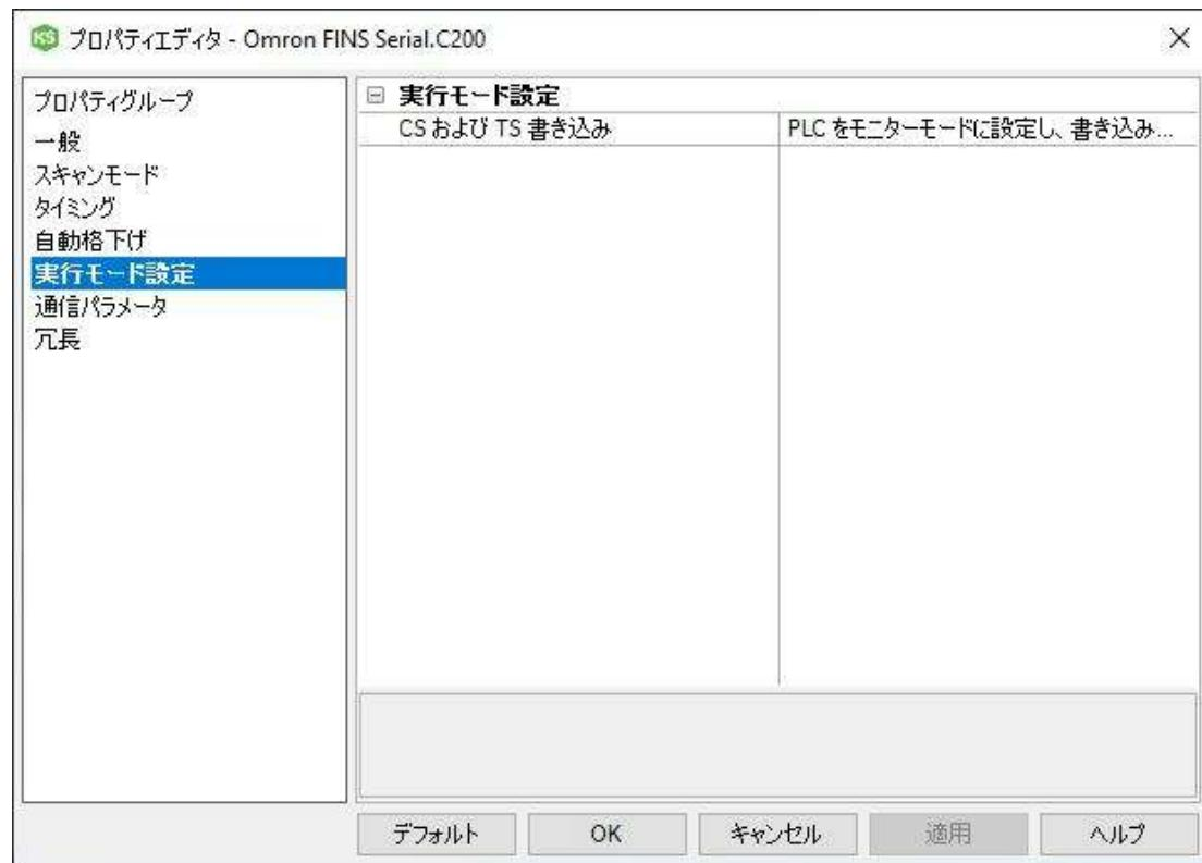
「CS および TS 書き込み」: デバイスが実行モードでどのように書き込みを行うかを選択します。デフォルト設定は「書き込みを失敗させ、メッセージをログに記録」です。
