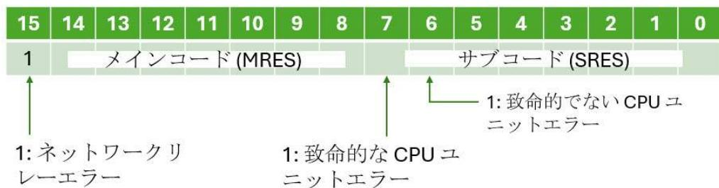
ビット 6 または 7 が ON の場合、宛先 CPU ユニットでエラーが発生しています。その場合、エラーが発生した CPU ユニットの取扱説明書を参照し、エラーの原因を取り除いてください。
