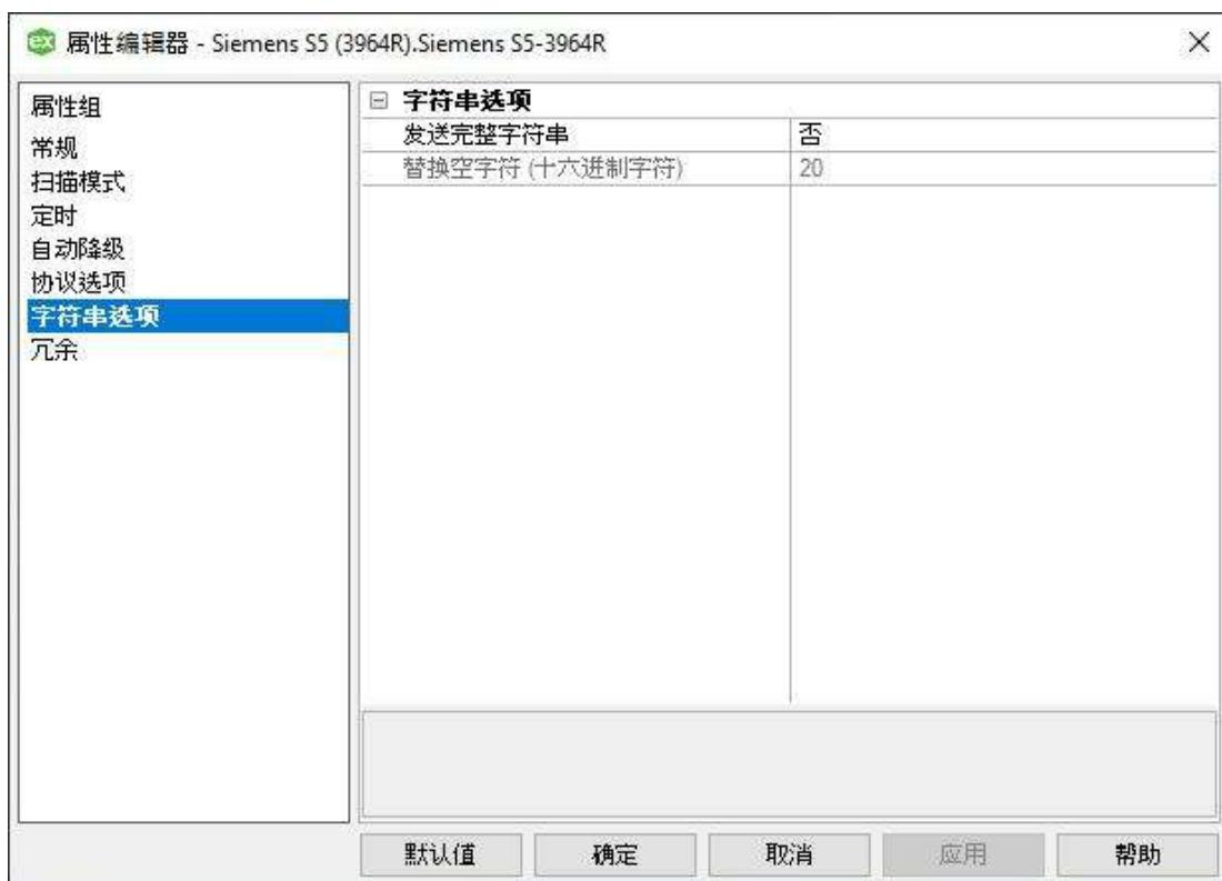
**“发送完整字符串”:** 发送到客户端的字符串默认终止于数据中遇到的第一个空字符 (0x00)。如果数据中不存在空字符，则会在传递字符串的末尾放置一个。还可以启用“完整字符串”，将内存范围中的所有字符发送到客户端应用程序。将所有空字符替换为用户指定的字符，以允许客户端应用程序显示完整的数据范围。默认值为“否”。
