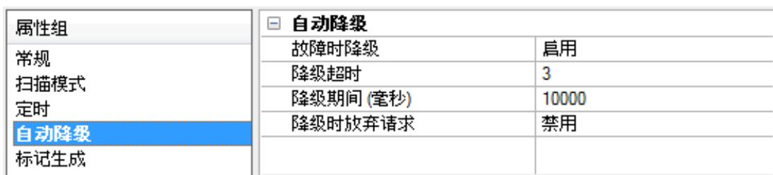
**“故障时降级”：**启用后，将自动对设备取消扫描，直到该设备再次响应。
