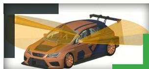
**Progettazione ergonomica migliorata.** I più recenti miglioramenti di Creo consentono di tenere conto dell'intervallo di movimento, del campo visivo e dell'unicità degli utenti in modo sicuro ed efficiente. Il campo visivo è in grado di eseguire l'analisi riflesso e i manichini possono supportare più involucri a portata.
