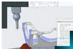
*Programación de la máquina de medición por coordenadas (CMM) para la inspección de calidad digital*
