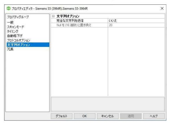
「完全な文字列を送信」: デフォルトでは、クライアントに送信される文字列は、データ内の最初の Null 文字 (0x00) によって終端されます。 データに Null 文字がない場合、渡される文字列の末尾に Null 文字が配置されます。 "完全な文字列" を有効にすることによって、メモリ範囲内のすべての文字をクライアントアプリケーションに送信することも可能です。 クライアントアプリケーションで範囲内のすべてのデータが表示されるようにするため、ユーザーが指定した文字にすべての Null 文字が置き換えられます。 デフォルトは「いいえ」です。
