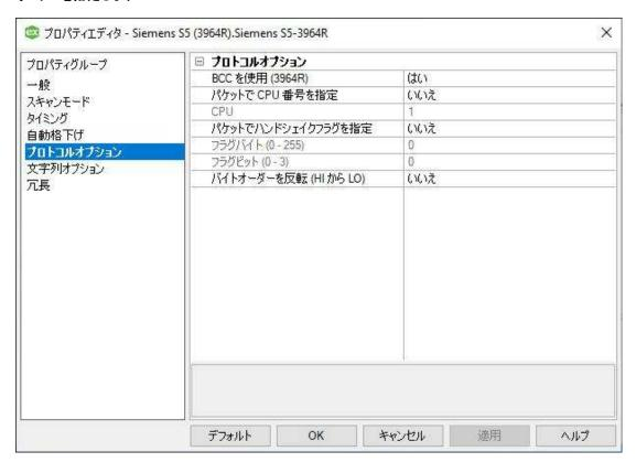
「BCC を使用 (3964R)」: ほとんどのデバイス構成で、通信エラーチェックの手段としてバイトチェック文字 (BCC)を使用する 3964R プロトコルバージョンが使用されます。 まれに、 3964 プロトコルバージョンが使用されることもあります。 このバージョンはバイトチェック文字を使用しない点を除けば 3964R と同じです。 デフォルトは「はい」であり、 BCC を使用します。
