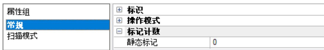
**“静态标记”:** 提供此级别 (设备或通道) 上已定义静态标记的总数。此信息有助于排除故障和平衡负载。
