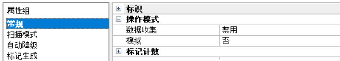
**数据收集:** 此属性控制设备的活动状态。尽管默认情况下会启用设备通信, 但可使用此属性禁用物理设备。设备处于禁用状态时, 不会尝试进行通信。从客户端的角度来看, 数据将标记为无效, 且不接受写入操作。通过此属性或设备系统标记可随时更改此属性。
